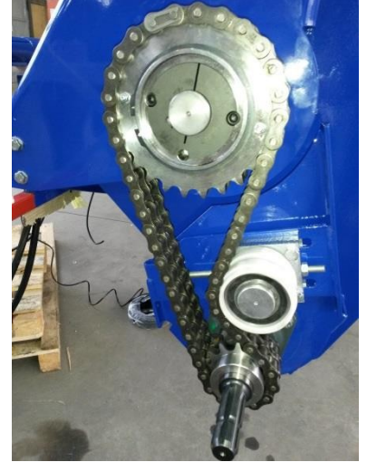
Fig. 3 Tandhjul med forskydningsbolte
